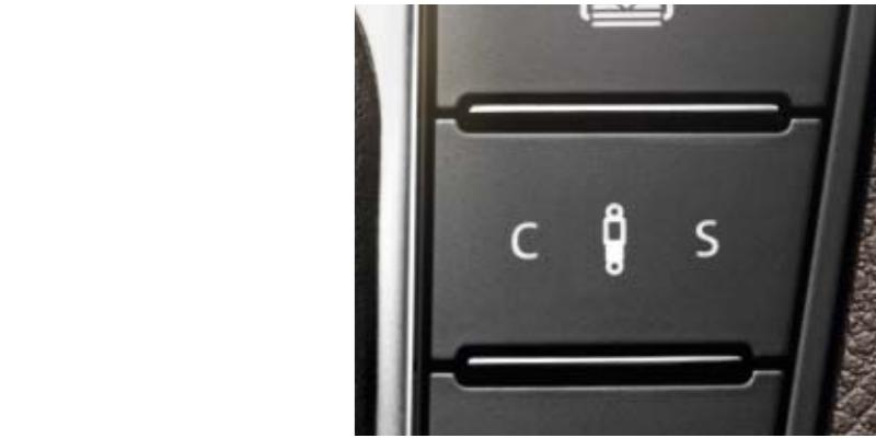
Der Schalter für die adaptive Fahrwerksregelung DCC befindet sich neben dem Schalt- bzw. Wählhebel. Hier kann der Fahrer zwischen den drei Grundeinstellungen „SPORT“, „NORMAL“ und „COMFORT“ wählen.
